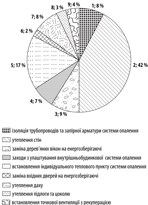
Рис. 5.8. Усереднена структура економії енергоресурсів при здійсненні заходів з термомодернізації житлових будинків, %
