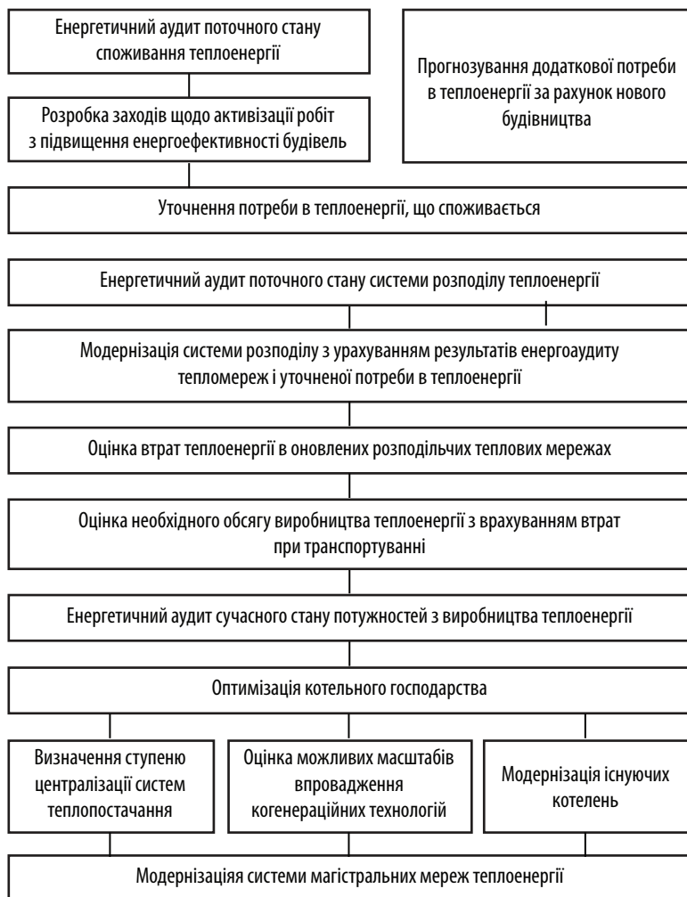
Рис. 3.8. Послідовність заходів з удосконалення технологій споживання, транспортування і виробництва теплоенергії
