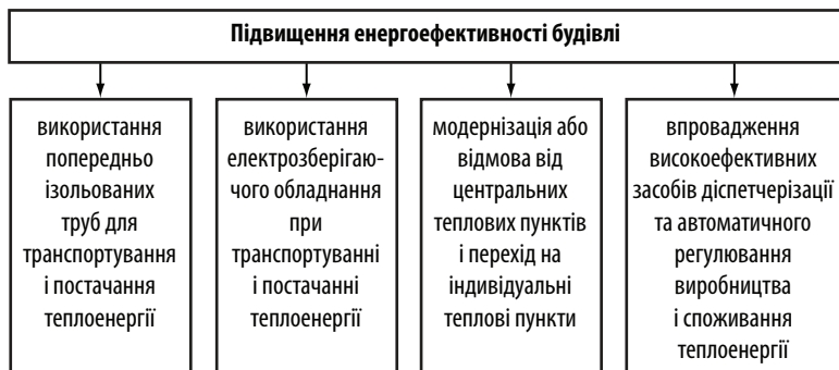
Рис. 5.9. Шляхи вдосконалення системи транспортування і постачання теплової енергії
