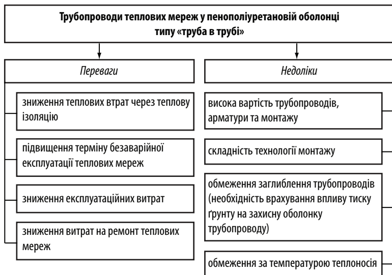
Рис. 5.10. Переваги та недоліки застосування попередньо ізованих трубопроводів
